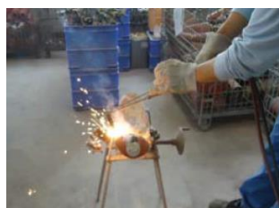
回収消火器の解体の様子
