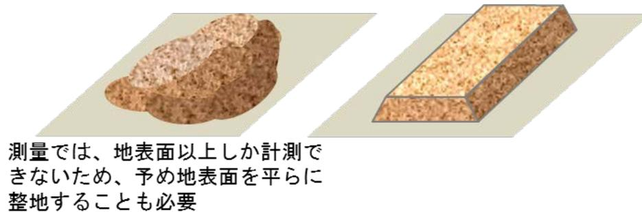
図 5.4-6 廃棄物の整形（計量していない場合）のイメージ
