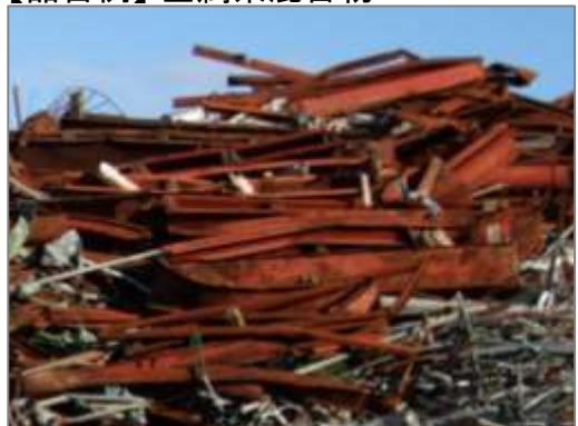
※ 鋼材が主体の混合物
