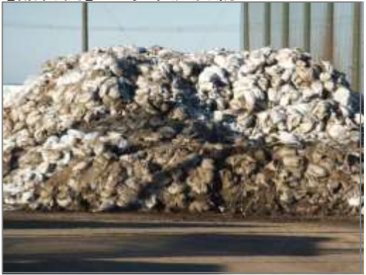
※ 土のう袋入 ※ 再生資材とするためには、土のう袋を取り除く必要がある
