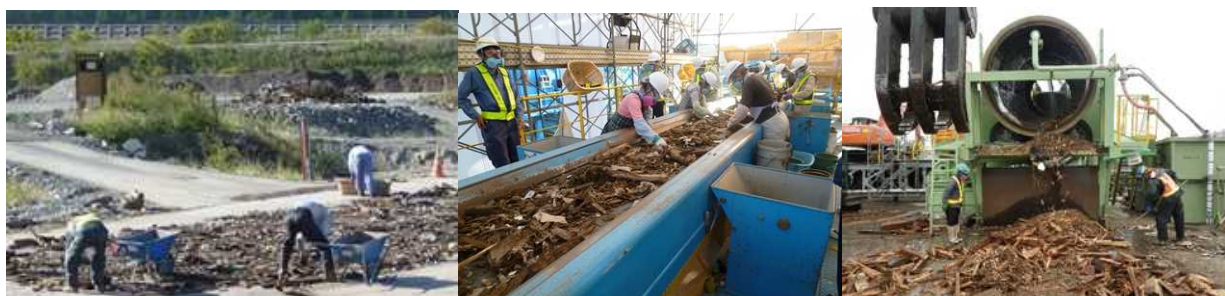
【ヤードにおける人力手選別：出典大阪府】 【ベルトコンベアによる手選別：出典大阪府】 【トロンメルによる廃木材洗浄：出典鴻池組】
